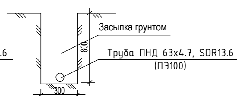
Поперечный разрез кабельной канализации
