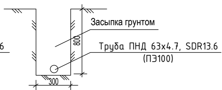
Поперечный разрез кабельной канализации
