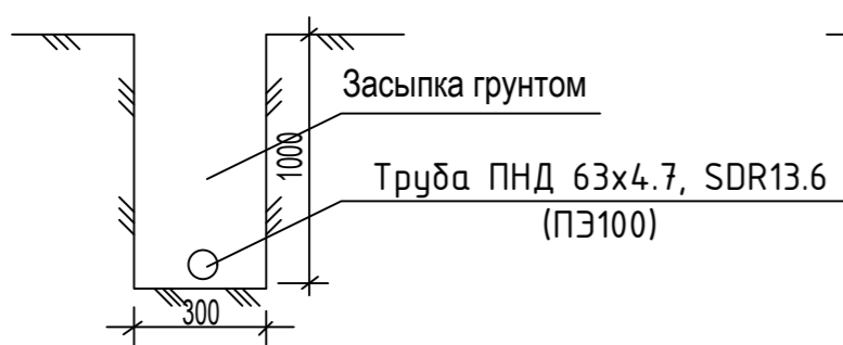
Поперечный разрез кабельной канализации (пересечение дороги)
